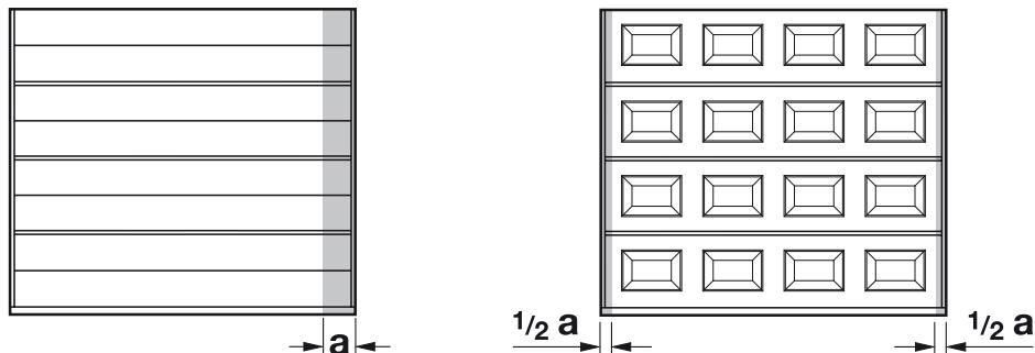
$a = \text{max. } 125 \text{ mm}, LZ \leq 2500 \text{ mm}$
