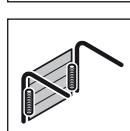
Направляющая с пружинами растяжения
