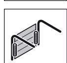
Prowadzenie z mechanizmem sprężyn naciągowych
